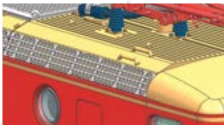
Corrimani separati e griglie di ventilazione analoghe all'originale sul tetto spiovente
