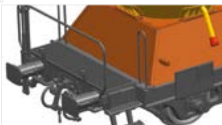
Piattaforma di manovra dettagliata con griglia traforata
